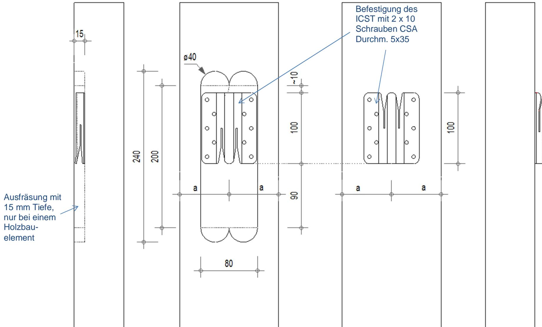
Beide Elemente des ICST müssen mit gleichem Abstand zum Balkenrand montiert werden. Sie stehen sich also gegenüber wenn die Montage abgeschlossen ist.
