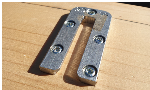
Image 1 Vissage d'un élément de fixation sans réglage du couple. Le connecteur s'enfonce dans le bois
