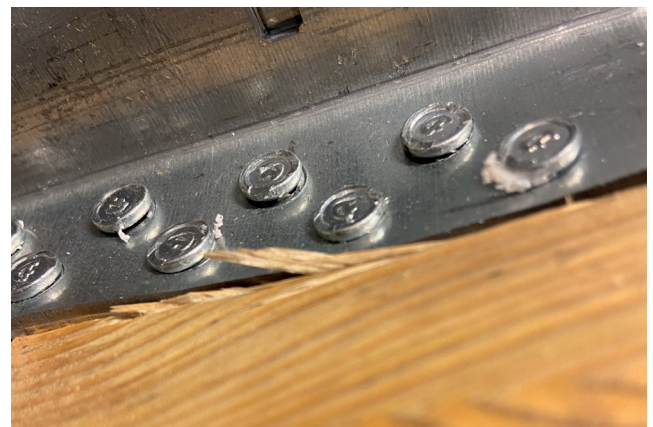
Bild 2: Eindrücken und Durchtrennen der Holzfasern aufgrund überhöhter Drucklufteinstellung
