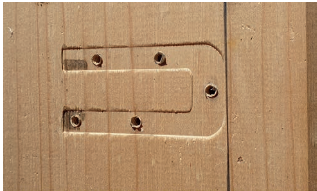
Bild 2 Erhebliche Eindrückungen durch eine zu starke Verschraubung
