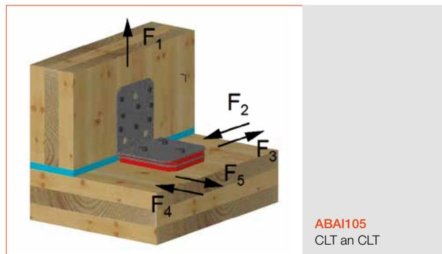
**i** Der ABAI105 ist ein Winkelverbinder, der für statisch tragende Verbindungen zwischen Wand- und Deckenelementen aus Brettsperrholz verwendet wird. Durch den besonderen Aufbau des ABAI wird ein statischer Anschluss der Holzteile ohne Einbußen beim Schallschutz ermöglicht.
