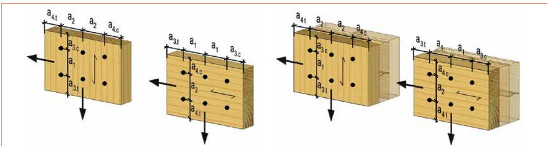
Definition der Achsabstände und Bauteilränder für stiftförmige Verbindungsmittel in CLT
