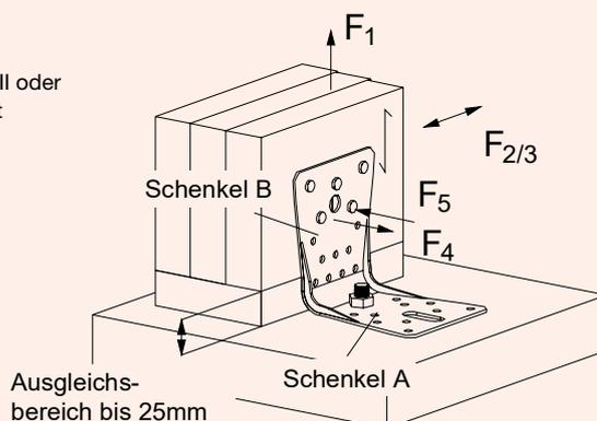
**B.** Verankerung von Holz auf Beton bei hohen Schubkräften**Schubverankerung von CLT-Wänden an Beton oder Stahl****Verbinder für Schubbeanspruchung (F2/3) von CLT-Wänden unmittelbar auf CLT oder Beton aufgelagert für mittlere bis hohe Lastbereiche**
