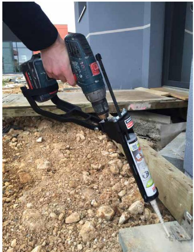
Anwendung mit Injektionsmörtel
