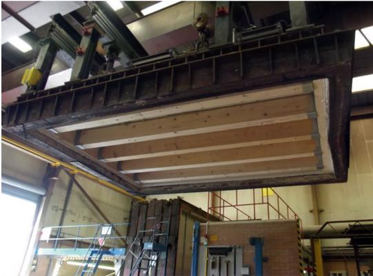
Einheben eines Deckenbalkenelementes auf die Brennkammer
