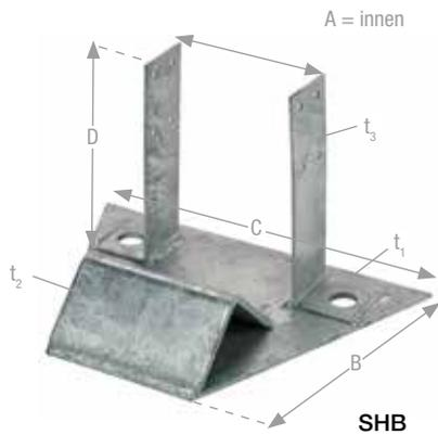
SHB Sparrenhalter für Anschlüsse an Beton und SHH Sparrenhalter für Anschlüsse an Holz werden für die Befestigung von Sparren mit einer Neigung von 30° bis 60° am Fußpunkt verwendet. Der aufgeschweißte Winkel weist immer 45° zur Grundfläche auf. Die Kerne im Sparren wird an den Winkel, abhängig von der Dachneigung angepasst.
