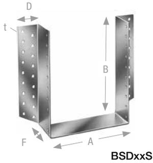
BSD und BSDI Balkenschuhe sind für zahlreiche Hauptträger- Nebenträger, bzw. Stützen- Nebenträgerverbindungen anwendbar. Die geringe Auflagertiefe von nur 52 mm erlaubt eine verdecktliegende Montage in Installationsebenen im Holzrahmenbau. BSD mit außenliegenden Schenkeln können nach konstruktionsbedingten Vorgaben mit Bolzenlöchern zum Anschluss an Beton oder Stahl hergestellt werden.
