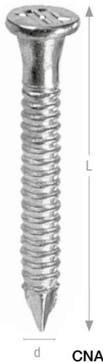
CNA Kammnägel wurden speziell für die Befestigung von Simpson Strong-Tie® Holzverbindern entwickelt. Der konische Ansatz des Schaftes unter dem Nagelkopf gewährleistet bei Stahlblech-Holz-Nagelverbindungen eine exakte Kraftübertragung. Die Werte der Tragfähigkeit sind in der ETA bzw. EN geregelt. CNA Kammnägel sind zur Identifizierung im eingeschlagenen Zustand, auf dem Kopf mit der Nagellänge gekennzeichnet.
