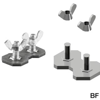
BF Clips bestehen aus einem Trägerblech und zwei eingepressten M5 Schrauben mit Flügelmuttern und werden für die Verbindung von Windrispenbändern an die Anschlussbauteile des Windaussteifungssystems verwendet.
