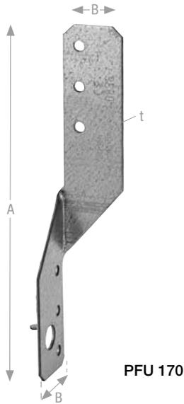
PFU Pfettenanker werden für die Zugverankerung von sich kreuzenden Hölzern verwendet. Ebenso können horizontale Kräfte aufgenommen werden. Belastungsabhängig kommen 2 oder 4 Pfettenanker pro Anschluss zur Anwendung. PFU Pfettenanker sind links und rechts verwendbar. Die Einschlagzacke dient als Montagehilfe.
