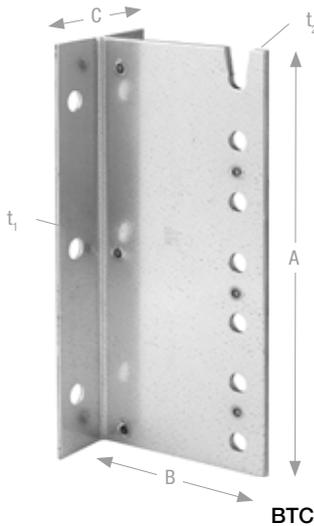
BTC Balkenträger wurden für Anschlüsse mit Bolzen an Beton oder Stahl entwickelt und mit einem längeren Schwert ausgestattet, um den Mindestabstand der Stabdübel vor den Bolzenköpfen zu gewährleisten. Durch die verdeckt liegende Montage eignen sie sich sehr gut für Sichtholzkonstruktionen und können bei Anforderungen an den Brandschutz sicher eingesetzt werden.
