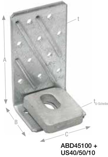
ABD45100 Winkelverbinder sind durch die variablen Ausnagelungsmöglichkeiten vielseitig einsetzbar. Vor allem an Beton, in Verbindung mit der U-Scheibe US40/50/10 und nur einem Bolzen Ø12 mm, sind die Winkel sehr leistungsfähig.
