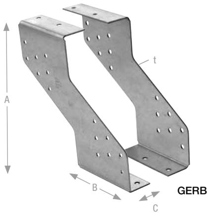
GERB Gerberverbinder werden für die Gelenkausbildung von Durchlaufträgern verwendet. Ein Satz Gerberverbinder besteht aus einem rechten und einem linken Anschlussstück und kann für Pfettenbreiten ab 80 mm eingesetzt werden. GERB Gerberverbinder sind für die gängigsten Holzabmessungen erhältlich.
