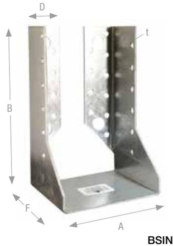
BSIN Balkenschuhe werden zur Verbindung von Nebenträgern mit Hauptträgern oder Stützen verwendet und dürfen in alle Richtungen belastet werden.
