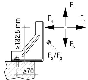
Die Anschlussbilder D bis F können auch für Stützenanschlüsse verwendet werden.
