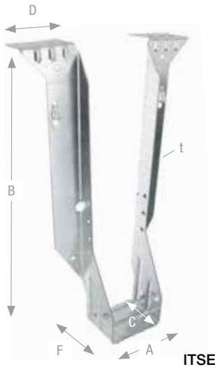
ITSE Verbinder werden hauptsächlich als Verbinder von Stegträgern an Hauptträger aus Vollholz, Holzwerkstoffen oder andere Stegträger verwendet. ITSE sind oberseitig mit Montageschenkeln ausgestattet und nur für Anschlüsse geeignet, bei denen die Neben- und Hauptträger oberkantenbündig eingebaut werden. Die Verbinder müssen die gleichen Höhen wie die Nebenträger aufweisen.
