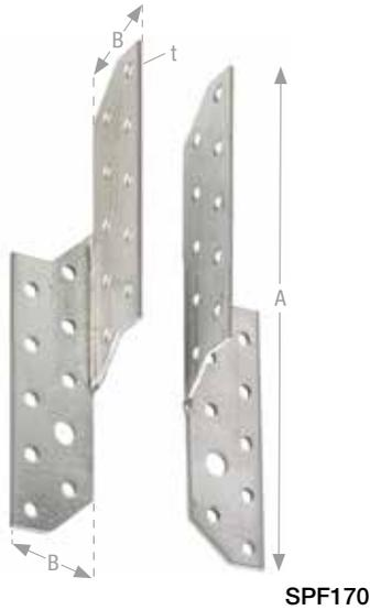
SPF Sparrenpfettenanker werden für die Zugverankerung von sich kreuzenden Hölzern verwendet. Neben Zugkräften können horizontale Kräfte aufgenommen werden. Belastungsabhängig kommen 2 oder 4 Pfettenanker pro Anschluss zur Anwendung. Bei Verwendung von zwei Sparrenpfettenankern sollten diese zur zentralen Lastenleitung diagonal gegenüberliegend angeordnet werden.
