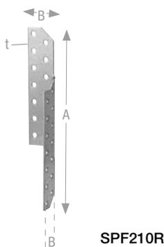
SPF Sparrenpfettenanker werden für die Zugverankerung von sich kreuzenden Hölzern verwendet. Neben Zugkräften können horizontale Kräfte aufgenommen werden. Belastungsabhängig kommen 2 oder 4 Pfettenanker pro Anschluss zur Anwendung. Bei Verwendung von zwei Sparrenpfettenankern sollten diese zur zentrischen Lastenleitung diagonal gegenüberliegend angeordnet werden.
