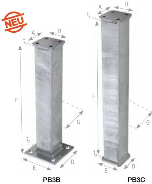
PB3B und PB3C Stützenfüße erfüllen die Anforderungen an den baulichen Holzschutz gemäß DIN 68800 und die Fachregeln des Zimmererhandwerks. Aufgrund der großen Rohrlängen werden die erforderlichen 300 mm freier Abstand zur Bodenoberfläche, auch bei hohen Stützlasten, sicher eingehalten.
