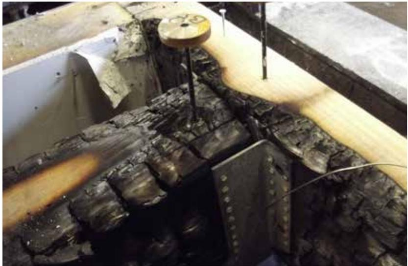
Für GSE und GSI Balkenschuhe in 4,0 mm Blechdicke und einer Breite ab 100 mm ist in der ETA-06/0270 die Brandbemessung bei einer direkten Beflammung, für die Feuerwiderstandsdauer von 30 Minuten geregelt.
