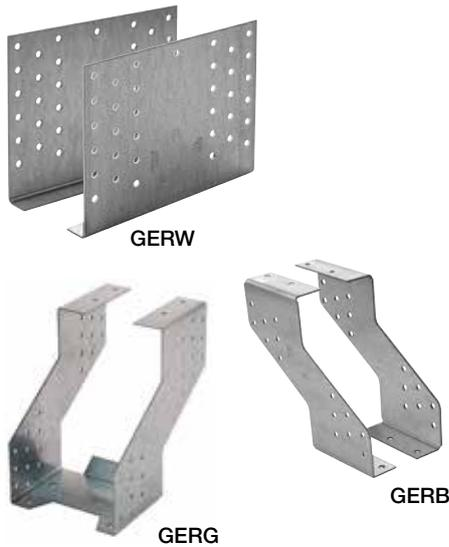
GERB, GERG Verbinder sind für Gelenksysteme geeignet, in denen keine Normalkräfte wirken. GERW Verbinder können zusätzlich Normalkräfte in Stabrichtung aufnehmen.
