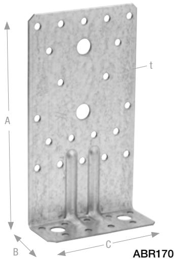
ABR170 und ABR220 Winkelverbinder mit Rippe sind für tragende Holzkonstruktionen geeignet, bei denen große Kräfte übertragen werden müssen. Durch die langen Schenkel und die besondere Anordnung der Löcher, sind die Winkel sehr gut für Stützenanschlüsse, Fassadenstiele und für den Anschluss von hohen Deckenbalken auf Holz- oder Betonauflegern geeignet.
