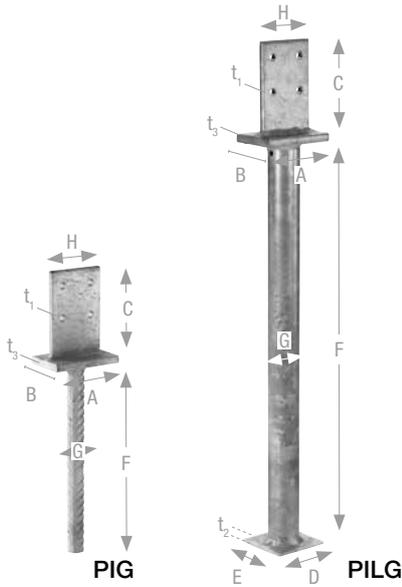
PIG / PILG Stützenfüße sind für Holzbreiten ab 60 mm geeignet und werden direkt im Beton eingesetzt. Dabei darf der maximale Abstand der Druckplatte zum Beton beim Typ PIG 50 mm und beim Typ PILG 250 mm betragen. Es können vertikale und horizontale Lasten aufgenommen werden.
