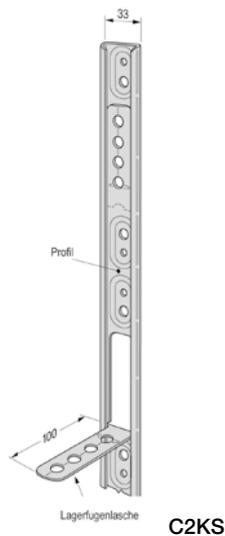
C2KS Maueranschlussschienen sind ein Verbindungssystem, das mit den meisten gängigen Block- und Steinformaten bei Um- und Neubauarbeiten verwendet werden kann. Sie werden zur Verbindung neuer Mauerwerkswände an Bestandskonstruktionen eingesetzt.
