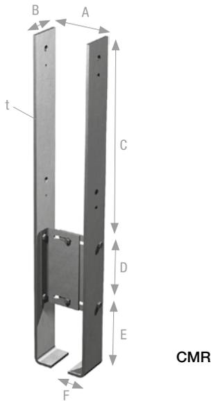
Die CMR / CMS Stützenfüße sind zur Herstellung von eingespannten Stützen, z.B. bei Carports, kleineren Hallen o.ä. bei denen keine Wandverbände eingesetzt werden sollen, vorgesehen. Die breitenverstellbaren Stützenfüße können Druckkräfte, Zugkräfte und Momente in beide Achsrichtungen aufnehmen.
