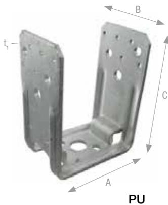
PU Stützenfüße werden direkt auf den Untergrund aufgestellt und mit Ankerbolzen oder Holzschrauben befestigt. Die 24 mm hohen Stufen im unteren Bereich halten das Holz auf Abstand.
