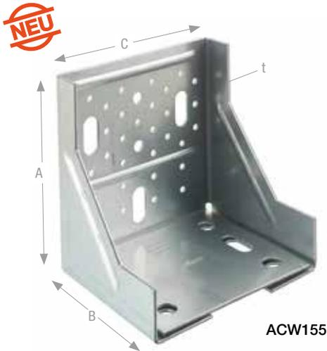
ACW155 Konsolwinkel sind leistungsstarke Verbinder aus 2,5 mm dickem Blech mit Flächenverstärkung. Sie werden überall dort eingesetzt, wo Schwell- oder Randhölzer vorwiegend an Beton oder Stahl angehängt, abgehängt oder aufgelagert werden müssen. ACW155 Konsolwinkel sind ebenso dazu geeignet, Vorhangfassaden an Betondecken zu befestigen.
