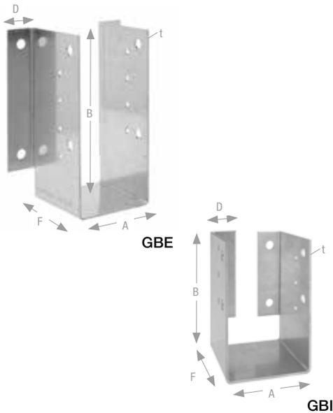
GBE / GBI Balkenschuhe wurden für Nebenträger mit großen Abmessungen zum Anschluss an Holz, Beton oder Stahl entwickelt. Sie kommen mit nur wenigen Verbindungsmitteln aus, wodurch sie relativ schnell montierbar und auch wieder lösbar sind. GBE / GBI Balkenschuhe sind für alle Lastrichtungen zugelassen und die 4 mm Blechdicke macht sie äußerst robust.
