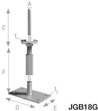
JGB18G Pfostenhalter werden mittels Ankerbolzen am Betonfundament angeschlossen. Das 16 mm Holzgewinde wird in eine Ø12 mm Bohrung bis zum Kontakt mit der Druckscheibe eingedreht. Durch die kraftschlüssige Verschraubung ist eine konstruktive Zugverankerung gewährleistet.
