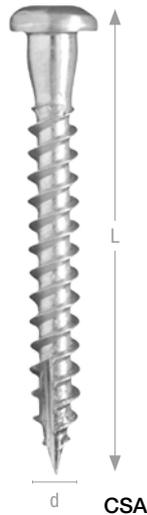
CSA Schrauben sind speziell für Stahlblech-Holz-Verbindungen entwickelt und zugelassen. Der passgenaue Ansatz des Schaftes unter dem Schraubenkopf gewährleistet eine akkurate Kraftübertragung auf die Lochleibung der Verbinder. Die scharfe Schneidspitze sorgt für ein exaktes und sofortiges Ansetzen der Schraube im Holz. Für die Randabstände sowie die Abstände untereinander gelten die gleichen Angaben wie für die CNA4,0xℓ Kammnägeln. Die Werte der Tragfähigkeit sind in der ETA geregelt.
