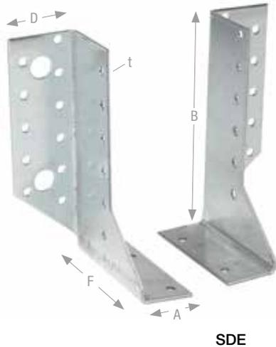
SDE sind zweiteilige Balkenschuhe und eignen sich insbesondere zur Anwendung bei Balken mit Zwischenmaßen und/oder bei Sanierungen mit wechselnden Holzbreiten.
