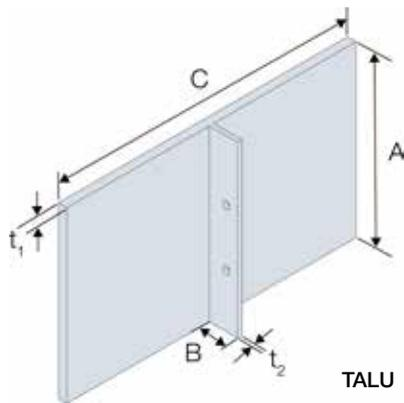
TALU3000 ist vielseitig einsetzbar und kann mit einem den Balkenträgern ähnlichem Bohrbild für gerade und schräge Anschlüsse verwendet werden.
