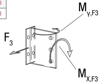
Es wird angenommen, dass die Kraft  $F_3$  am oberen Ende des BTC wirkt. Für eine Kraft  $F_3$  mit einem geringeren Abstand zur Mitte des BTC können die gleichen Tragfähigkeiten eingesetzt werden.
