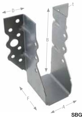
SBG Balkenschuhe sind zur Aufnahme in alle Lastrichtungen geeignet. Durch die präzisierte Nagelanordnung im Hauptträger können bei gleicher Tragfähigkeit bis zu 30 % Nägel eingespart werden. Die geringe Auflagertiefe von nur 55 mm erlaubt eine verdeckt liegende Montage in Installationsebenen im Holzrahmenbau.
