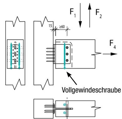
Werden die Nebenträger mit Abstand zum Hauptträger montiert, dürfen die Balkenträger in Lastrichtung  $F_1$ ,  $F_2$  und  $F_4$  beansprucht werden. Für die Lastrichtung  $F_3$  (rechtwinklig zur Einschubrichtung) darf die Fuge bis zur Nagelplatte des Balkenträgers maximal 3 mm betragen.
