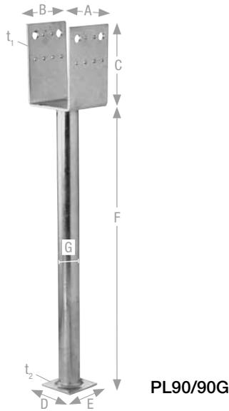
PLxxG Stützenfüße werden direkt im Beton eingesetzt und können Druck-, Zug- und horizontale Kräfte aufnehmen. Der Abstand der Unterkante des U-Profiles zum Beton darf bis 250 mm betragen.
