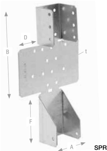
SPR Balkenschuhe sind in der Neigung verstellbar und ermöglichen eine Befestigung von Sparren an Holz oder Holzwerkstoff. Die Neigung ist bis zu einem Winkel von 45° nach oben oder unten gerichtet variabel.
