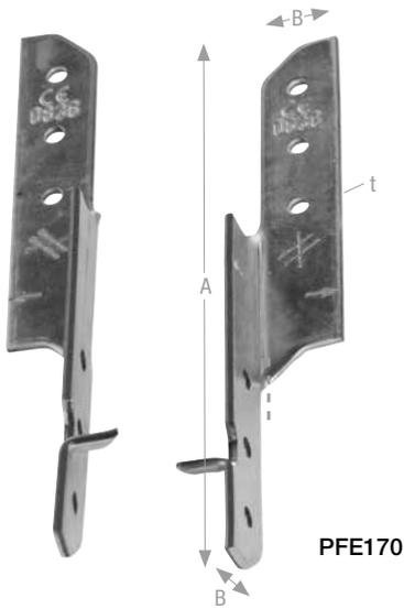
PFE Pfettenanker werden für die Zugverankerung von sich kreuzenden Hölzern verwendet und sollten vorzugsweise diagonal gegenüberliegend verbaut werden. Neben den Zugkräften können horizontale Kräfte aufgenommen werden. Belastungsabhängig kommen 2 oder 4 Pfettenanker pro Anschluss an der Anwendung. Bei 2 Pfettenankern pro Anschluss werden 2 linke oder 2 rechte Verbinder benötigt. Die PFE werden satzweise (rechts + links) verkauft. Die Einschlagzacke dient als Montagehilfe.
