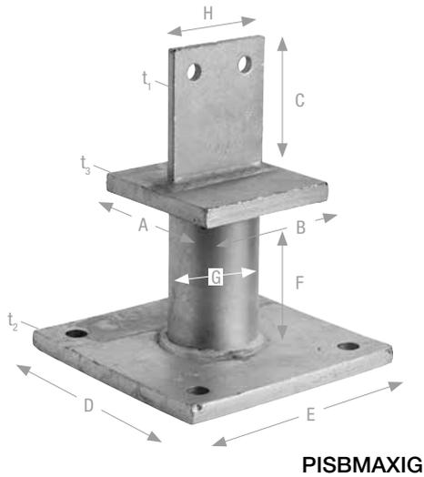
PISBMAXIG / PISMAXIG / PISBxxG / PIS70G Stützenfüße sind für mittelgroße Lastbereiche und für Stützenbreiten ab 80 mm geeignet. Die MAXI-Versionen decken den großen Lastbereich ab und sind für Stützenbreiten ab 120 mm gedacht. Bei den einbetonierbaren Typen PISxxG und PISMAXIG darf der Abstand ab Oberkante Beton bis zur Druckplatte maximal 150 mm betragen.
