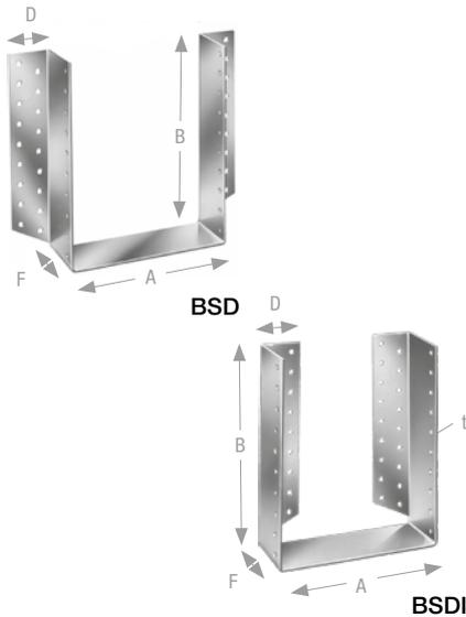
BSD / BSDI Balkenschuhe sind für zahlreiche Hauptträger- Nebenträger, bzw. Stützen- Nebenträgerverbindungen anwendbar. Die geringe Auflagertiefe von nur 52 mm erlaubt eine verdecktliegende Montage in Installationsebenen im Holzrahmenbau. BSD mit außenliegenden Schenkeln können nach konstruktionsbedingten Vorgaben mit Bolzenlöchern zum Anschluss an Beton oder Stahl hergestellt werden.
