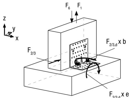
Es wird empfohlen die Bolzen oder Bolzengruppe mit der Software, z.B. Anchor Designer® von Simpson Strong-Tie® nachzuweisen.
