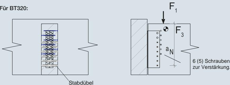
Die sechs Verstärkungsschrauben werden wechselseitig eingeschraubt, etwa mittig zwischen den Stabdübelabständen und in einem Abstand zur Balkenträgerhinterkante von ~10 mm, beginnend an der Lastangriffsseite, in diesem Fall von oben.
