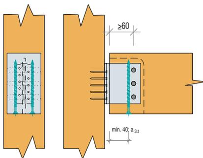
Werden die Nebenträger mit Abstand zum Hauptträger montiert, dürfen die Balkenträger in Lastrichtung  $F_1$ ,  $F_2$  und  $F_4$  beansprucht werden. Für die Lastrichtung  $F_3$  (rechtwinklig zur Einschubrichtung) darf die Fuge bis zur Nagelplatte des Balkenträger maximal 3 mm betragen.
