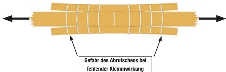
Bei Stabdübelanschlüssen mit mehr als sechs Stabdübeln sollte, sofern keine zusätzlichen Klemmbolzen vorgesehen sind, zur Erhöhung der Klemmwirkung etwa jeder sechste der statisch erforderlichen Stabdübel als Passbolzen ausgeführt werden.
