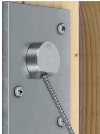
2. Das Holz sollte mit dem Kerndurchmesser der Schraube mindestens 1 cm tief angebohrt werden, damit ein exakter Einbau gewährleistet ist. Hierfür wird die Bohrhilfe BSZYK (vgl. Tab.2) verwendet. Die mitgelieferte Schraube wird durch das Loch im ZYKLOP™ in das Holz geschraubt. Die Schraube wird auf den letzten Millimetern mit geringer Drehzahl vollständig eingedreht.
