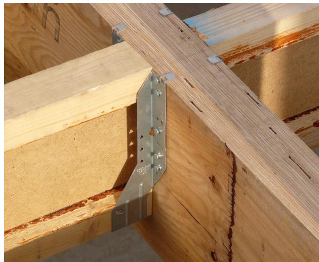
Die LSSU und LSSUI Verbinder sind für vertikal geneigte und/ oder horizontal schräge Anschlüsse geeignet. Eine Stegverstärkung ist in jedem Fall erforderlich. (siehe Seite 11)
