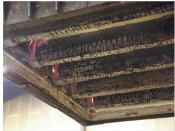
Abheben des Deckenbalkenelementes von der Brennkammer unmittelbar nach dem Versuch
