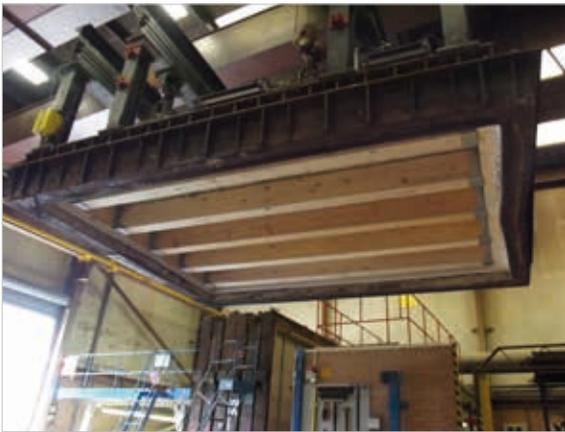
Einheben eines Deckenbalkenelementes auf die Brennkammer
