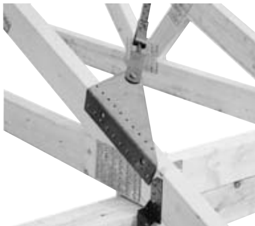
Detail am Traufpunkt: Bandanschluss G25 mit Spanngerät B25 Ø12 seitlich am Sparren mit Nägeln befestigt. Holzbreite: mind. 45 mm, max. 100 mm.
