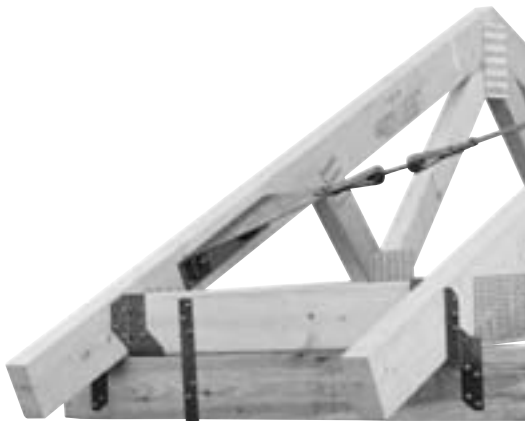
Detail am Traufpunkt: Bandanschluss G25 und Spanngerät B25 Ø12 mit Bolzen M12 durch den Sparren befestigt. In gleicher Weise kann der Bandanschluss G25 an Betongiebeln gehalten werden.
