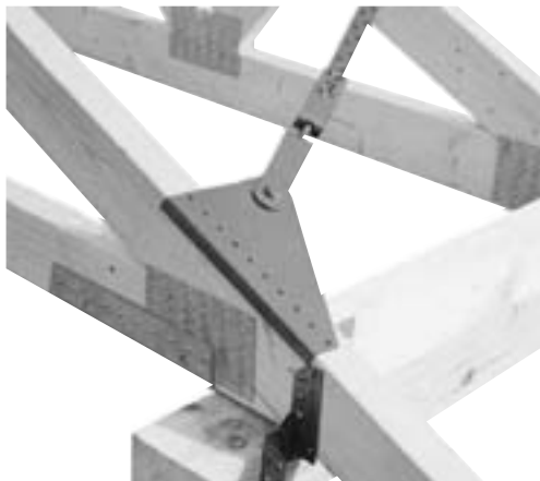
Detail am Traufpunkt: Bandanschluss F25 mit Spanngerät B25 Ø12 auf der Oberseite des Sparrens befestigt. Holzbreite: mind. 45 mm, max. 75 mm.
