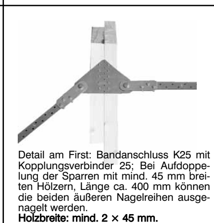
Detail am First: Bandanschluss K25 mit Kopplungsverbinder 25 nur in der mittleren Lochreihe ausgenagelt. Holzbreite: mind. 45 mm.
